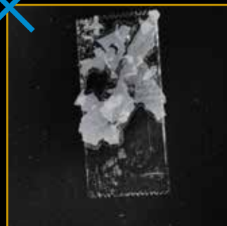
劣化クリアー層剥離 塗装不可
